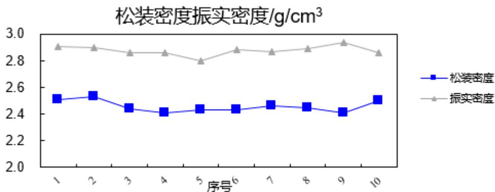
图 4 松装密度、振实密度测试
